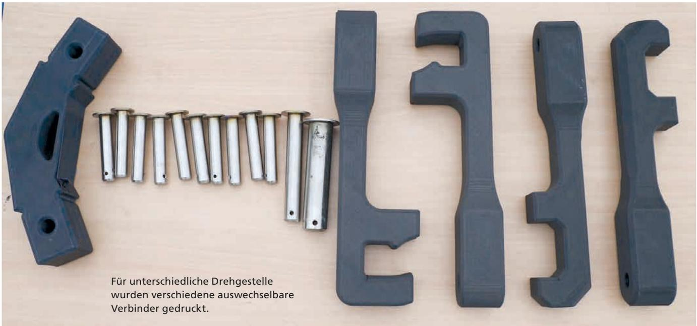
Für unterschiedliche Drehgestelle wurden verschiedene auswechselbare Verbinder gedruckt.
