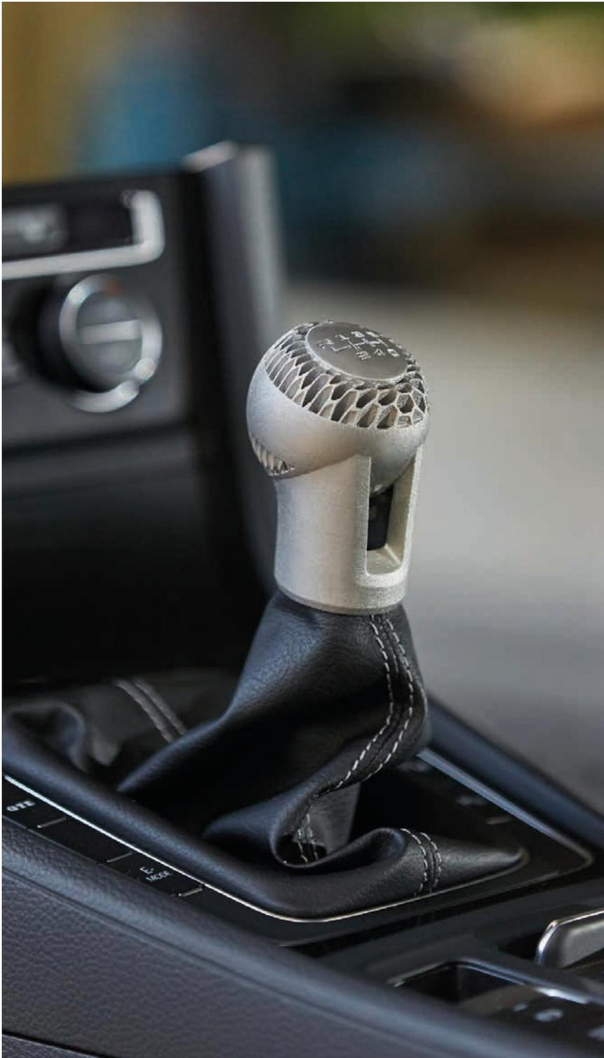
▲ Volkswagen plant die Fertigung individualisierter Fahrzeugteile auf den HP-Maschinen.
