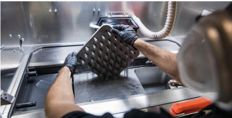
◀ 3D-Druck eignet sich nicht nur für Prototypen, sondern auch für Kleinserien komplexer Teile.
