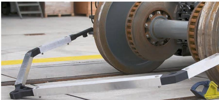
▲ Die 3D-gedruckten Teile halten die Belastung beim Ziehen und Bremsen der schweren Drehgestelle problemlos aus.
