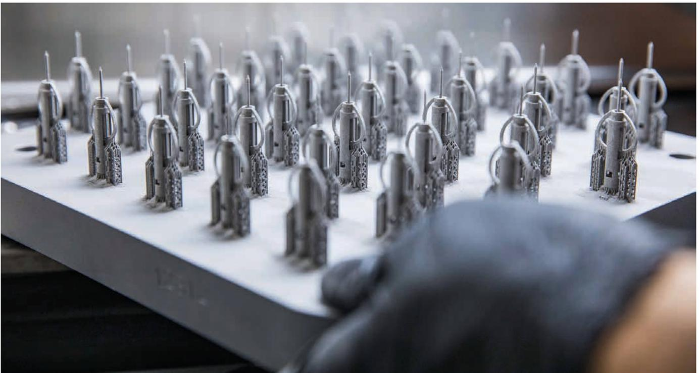
Der Metall-3D-Druck, beispielsweise im DMLS (Direktes Metall Laserintern)-Verfahren, bietet dem Konstrukteur fast unbegrenzte Möglichkeiten. Trotzdem erfordert das Verfahren einiges Know-how, um zuverlässig gute Teile aus dem Drucker zu erhalten. Aber auch die Gestaltung erfordert Erfahrung, damit beispielsweise das Pulver im Innern entfernt werden kann. Dienstleister wie Protolabs helfen hier mit ihrer Expertise, optimale Ergebnisse zu erhalten.
